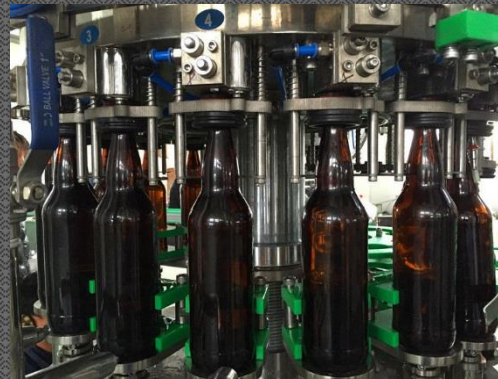
Poste de soutirage automatisé
