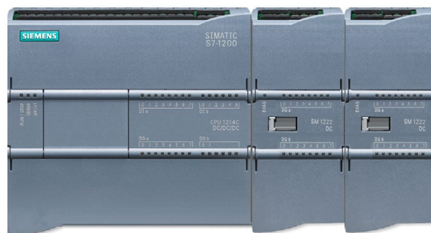
Figure 6-2 Installation réelle avec module configuré dans l'emplacement 3 absent, et module configuré pour l'emplacement 4 dans l'emplacement réel 3
