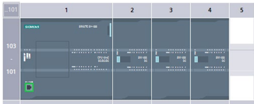
Figure 6-1 Configuration d'appareil d'installation maximum avec trois modules d'entrées-sorties
